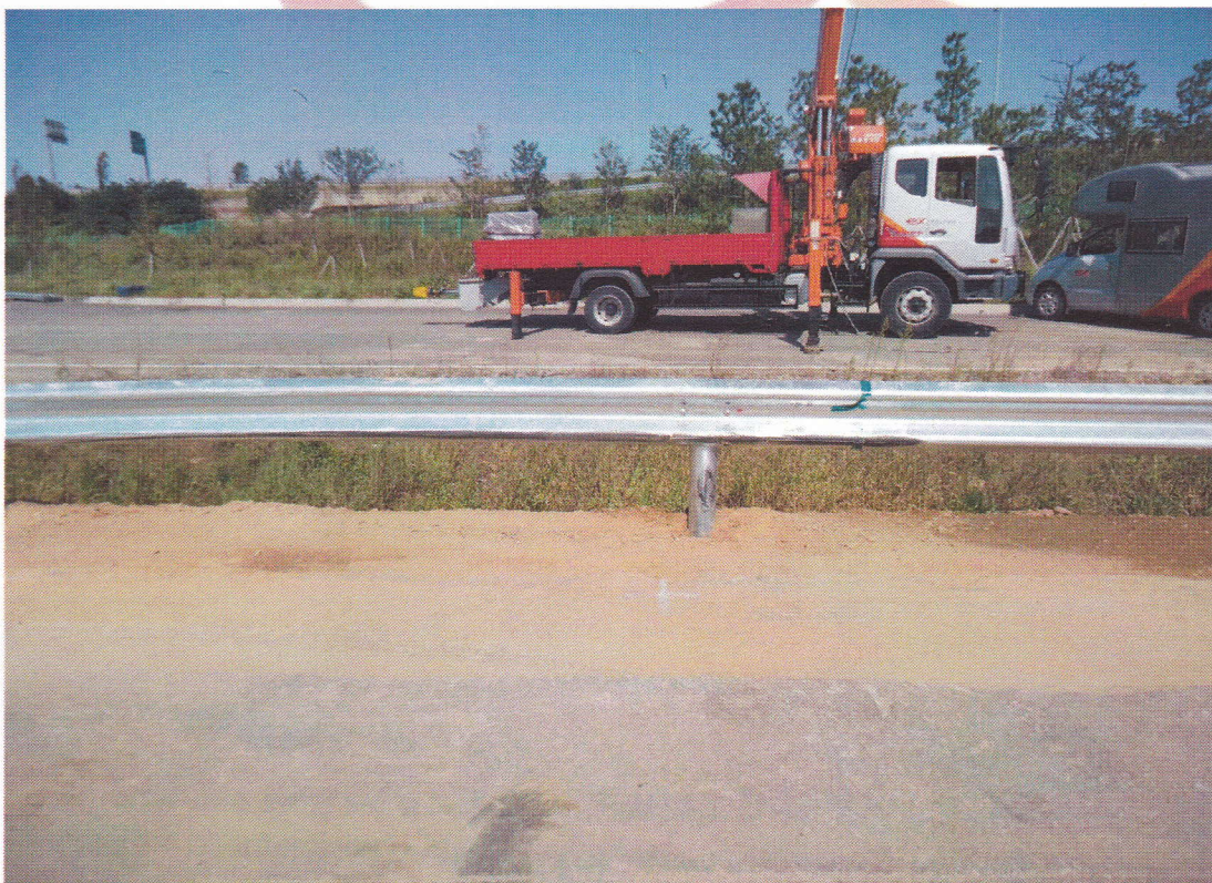
<소형차 시험 후 시설물 전면부>
